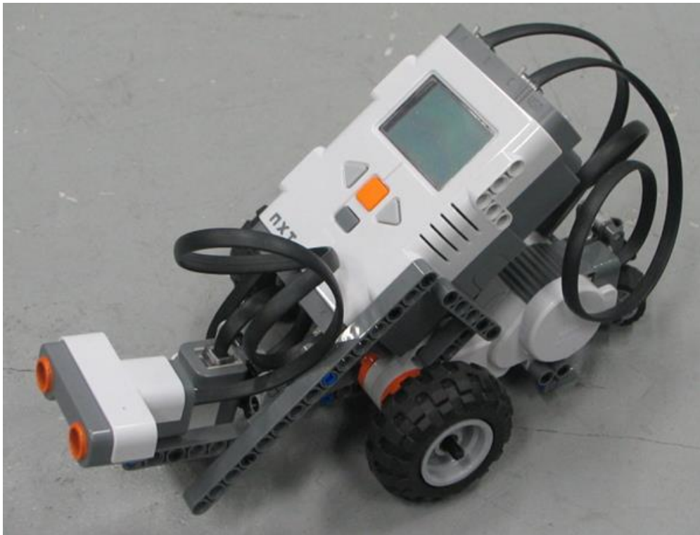
図2 今回作製した車両型ロボット 前方に超音波センサ（距離），下向きに光センサを取り付けている。
